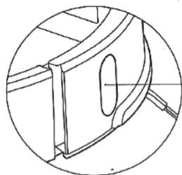
Датчик определения расстояния от стен
