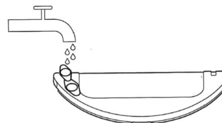
2. Заполнение емкости для воды: откройте крышку резервуара для воды, заполните ее водой и закройте крышку. Внимание: наименьшее количество средства для мытья пола или дезинфицирующего средства могут привести к порче фильтра.
