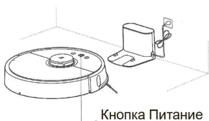
Нажмите и удерживайте кнопку Питание, чтобы включить устройство. Дождитесь пока включится кольцеобразный индикатор, после чего можно подключать устройство к док-станции на подзарядку.
