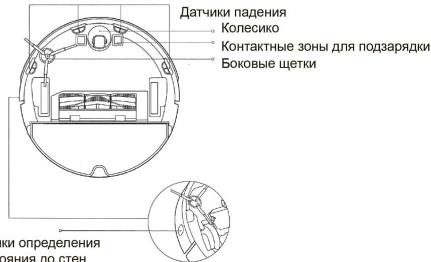
Датчики определения расстояния до стен
